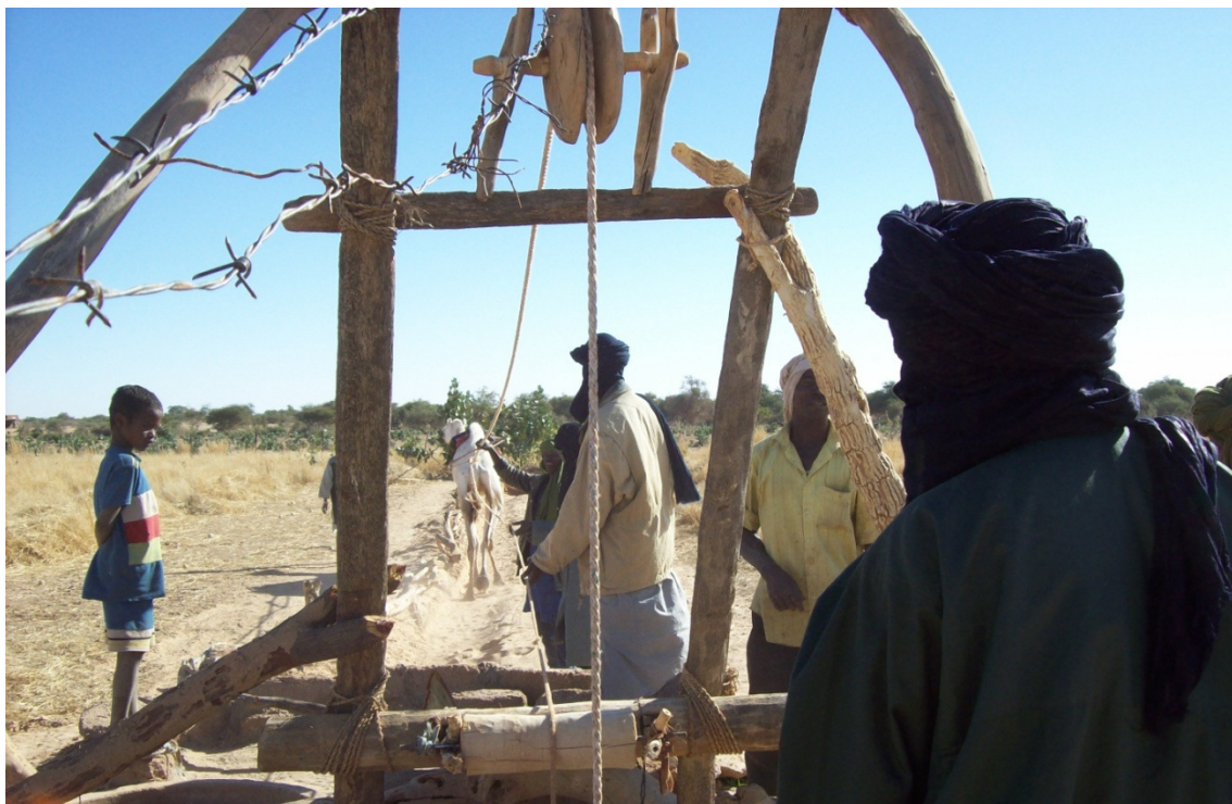
6. Le puits du site aménagé ci-dessus est équipé d'un matériel d'exhaure appelé locale le Délou utilisant le dromadaire pour tirer la puisette.
